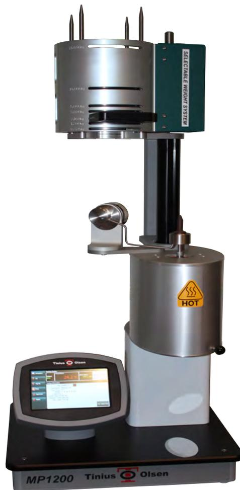
图中所示的MP1200熔融指数仪配备了辅助的多砝码系统, 其可作为MP1200的标准配置, 或作为现有的MP1200自动版的额外配件。
