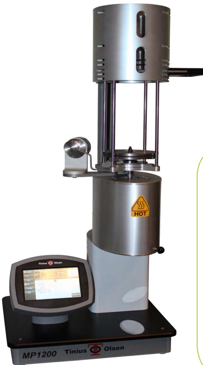
操作者只需通过插板选择所需要的砝码，并将它插入所需的配重卡槽内，相应砝码会自动加载到活塞杆上。
