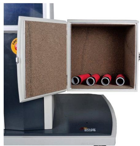
测试箱带软木内衬与试样管
