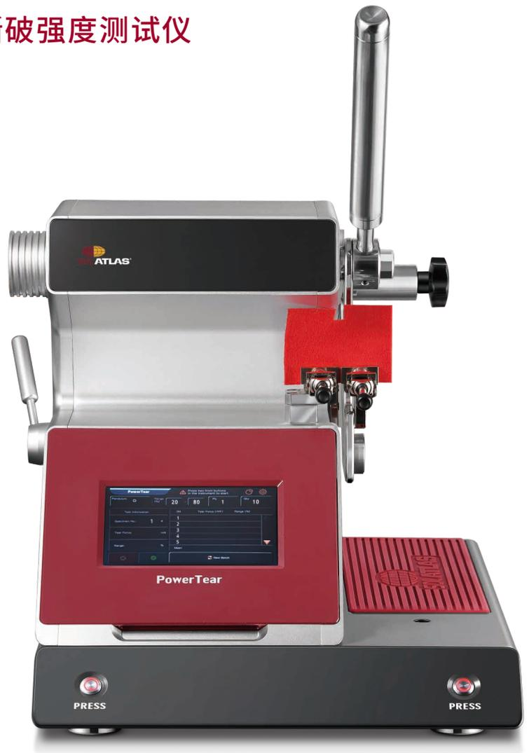
可将摆锤调整至零平衡的能力，提供更准确的结果。
