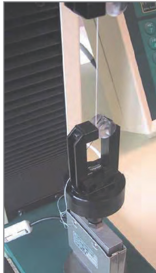
使用气动夹具进行 弹性纤维测试
