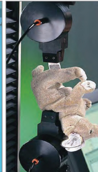
使用气动夹具进行 玩具测试
