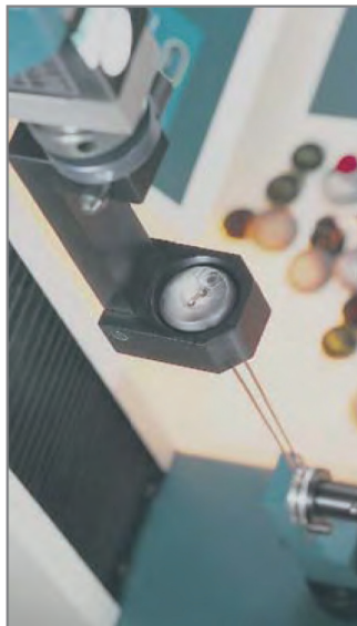
钮扣断裂测试
