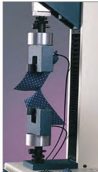
使用气动夹具进行 撕裂测试
